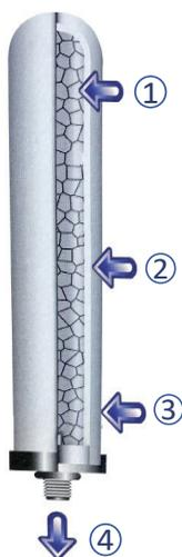
**Etape 1 :** Microfiltration par la coque extérieure céramique micro-poreuse.
